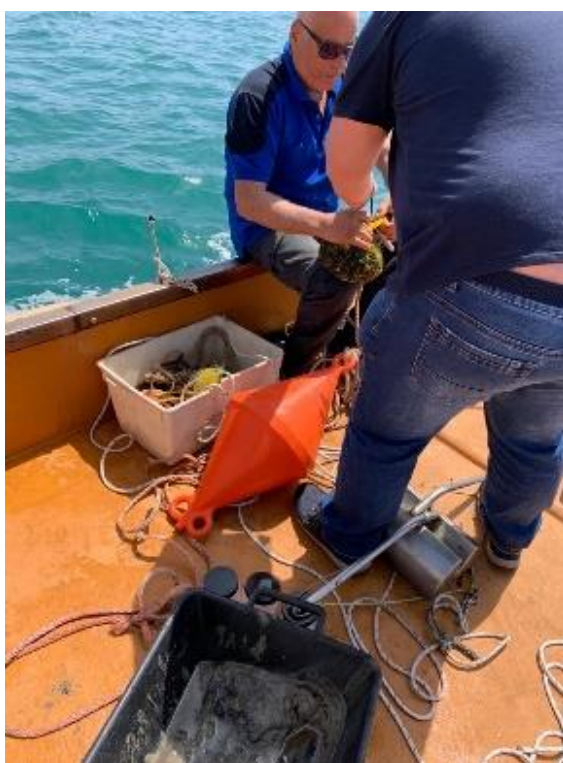
Fig. 2 - Motopontone attrezzato con benna Van Veen per il prelievo campioni
