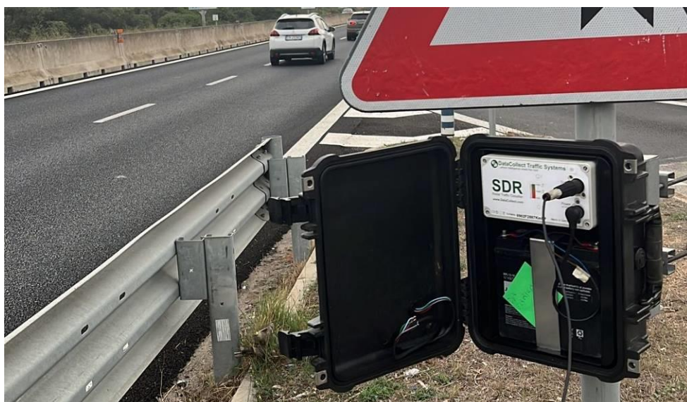
Figura 11 – Particolare dello strumento utilizzato per il conteggio del traffico veicolare della SS195
