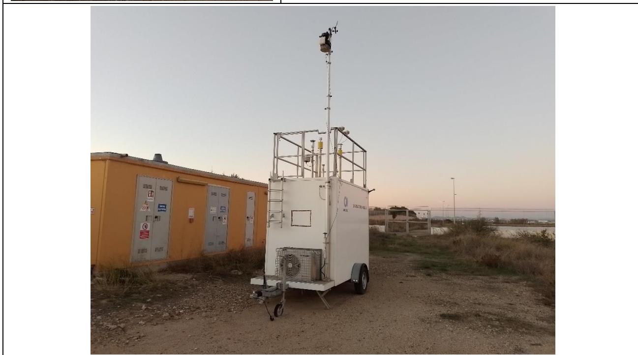
Monitoraggio atmosferico – laboratorio mobile strumentato
