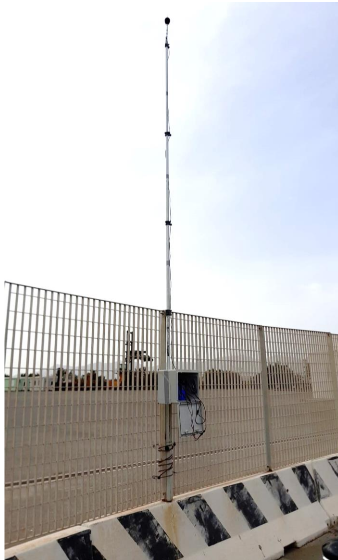
Monitoraggio acustico - Centralina con fonometro integratore e microfono su di un palo telescopico
