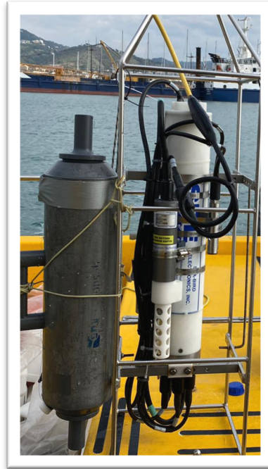
Fig. 4 – Sonda multiparametrica SBE 19 Plus V2
