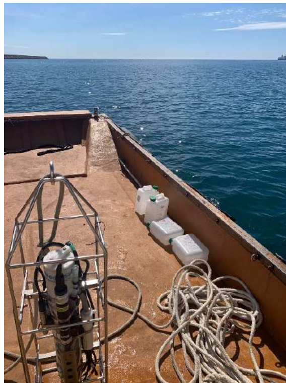
Fig. 4 - Sonda multiparametrica SBE 19 Plus V2
