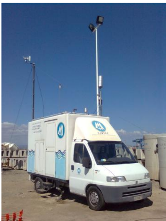
Figura 2.3 – Immagini del laboratorio mobile posizionato nel cantiere per il monitoraggio della qualità dell'aria
