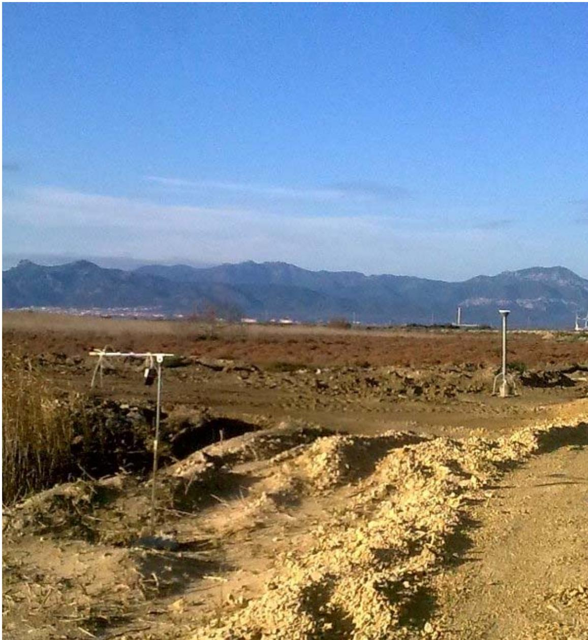
Figura 2.5 - Misuratore polveri totali e deposi metro (nello sfondo) nella stazione St. 3 (banchina e mare a destra)
