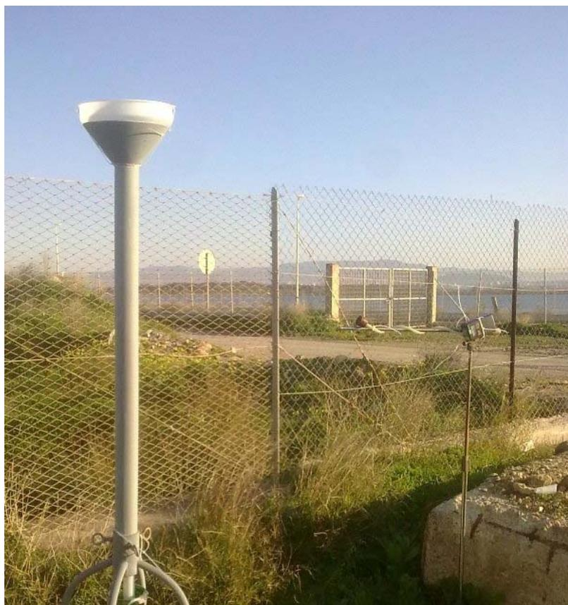
Figura 2.3 – Deposimetro St. 1 (ingresso cantiere Porto Canale)
