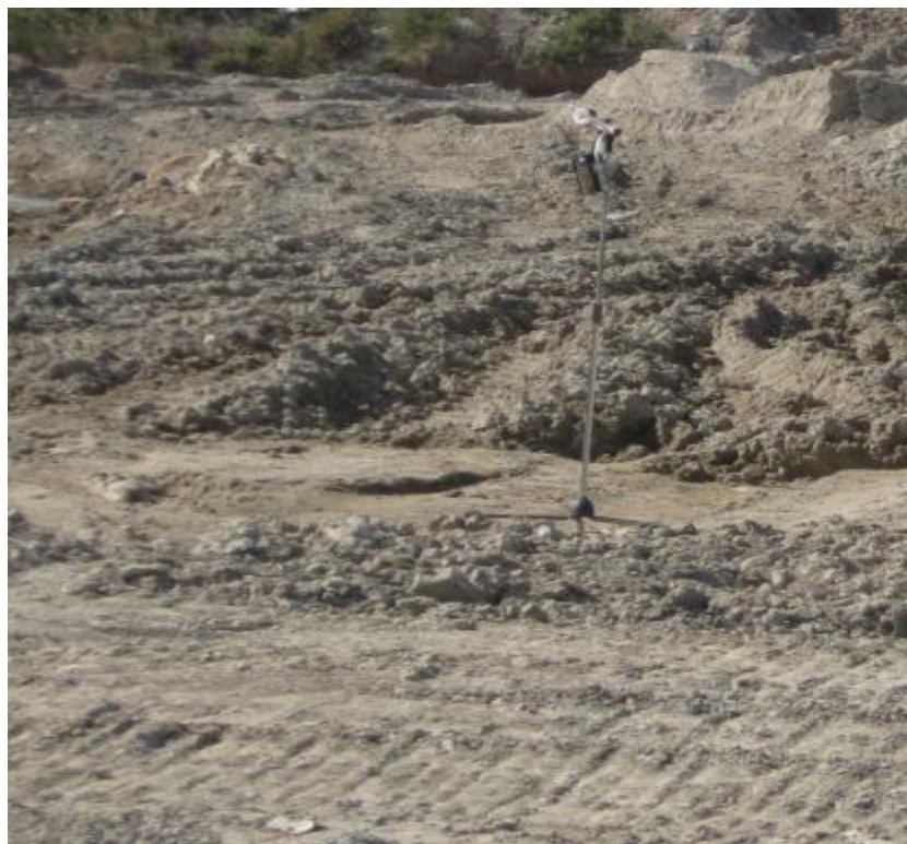
Figura 2.3 - misuratore polveri totali nella stazione st. 3.
