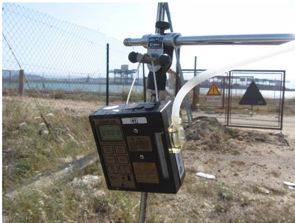
Figura 2.2 - misuratore delle polveri totali st. 1 (ingresso cantiere Porto Canale)
