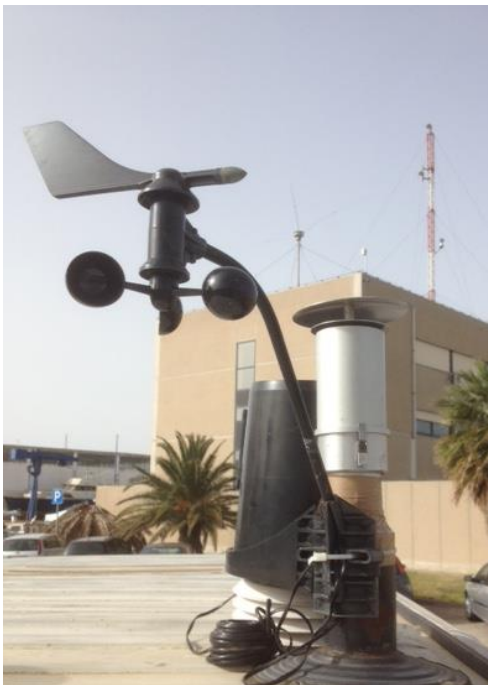
Foto 2: Centralina meteo fissa
