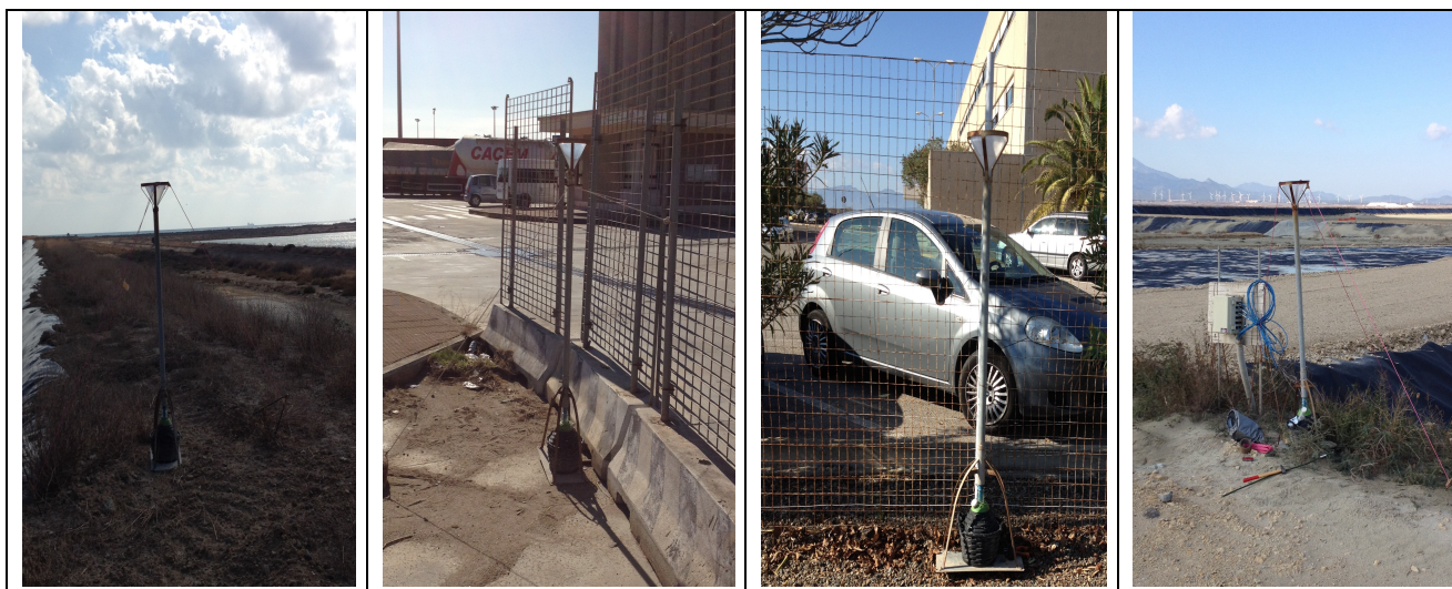
Foto 4: deposimetri installati rispettivamente nelle postazioni 01-02-03-04
