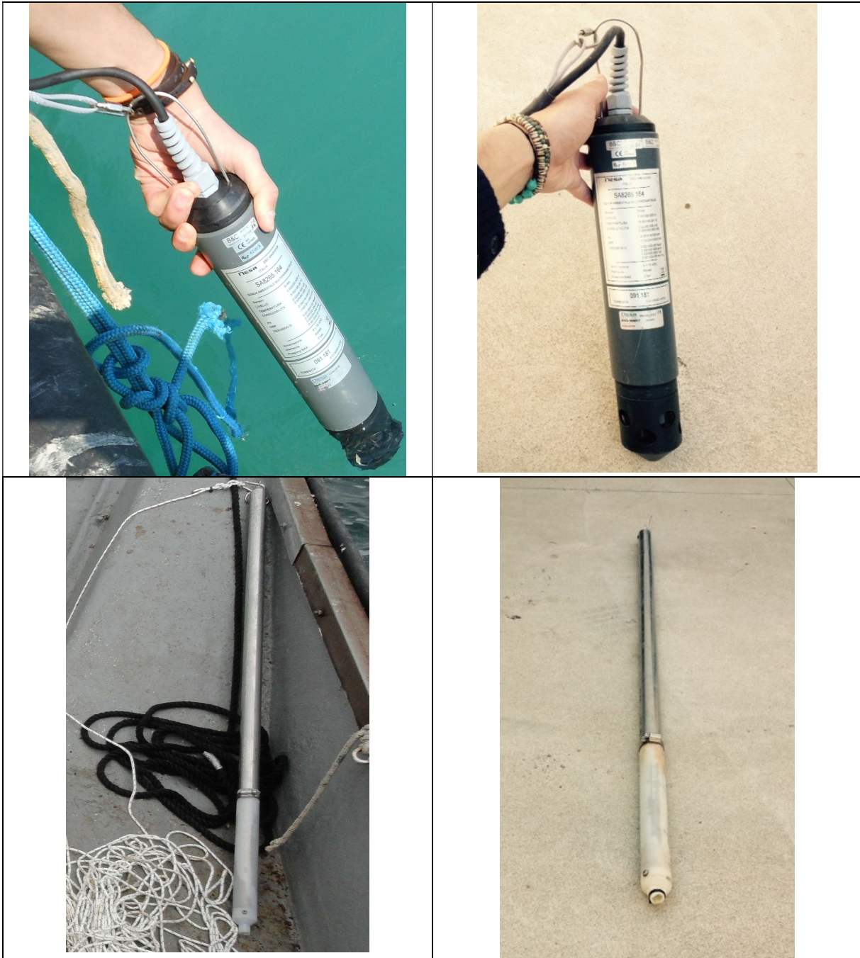
Foto 5: Sonda multiparametrica NESA e Bomb sampler utilizzato per il campionamento delle acque
