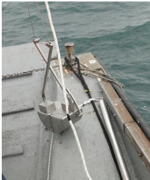
Foto 8: benna di Van Veen utilizzata per il campionamento dei sedimenti
