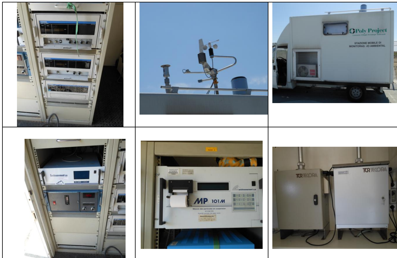
Foto 5: Mezzo mobile per monitoraggio della qualità dell'aria
