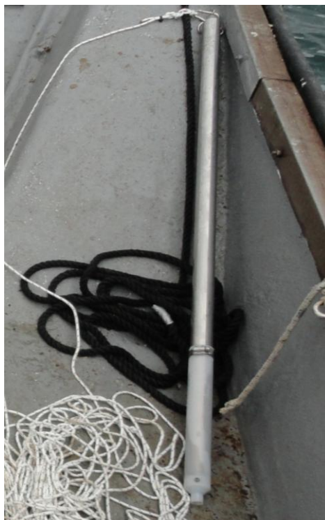
Foto 7: Bomb sampler utilizzato per il campionamento delle acque
