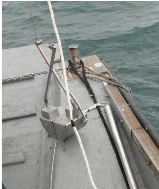
Foto 13: benna di Van Veen utilizzata per il campionamento dei sedimenti
