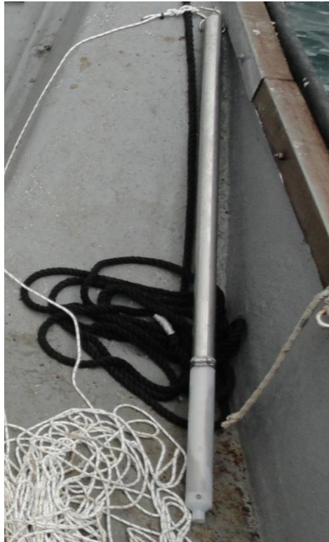
Foto 12: Bomb sampler utilizzato per il campionamento delle acque
