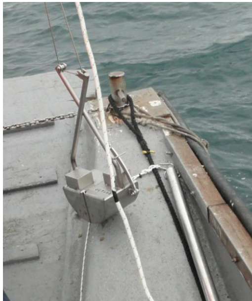
Foto 13: benna di Van Veen utilizzata per il campionamento dei sedimenti
