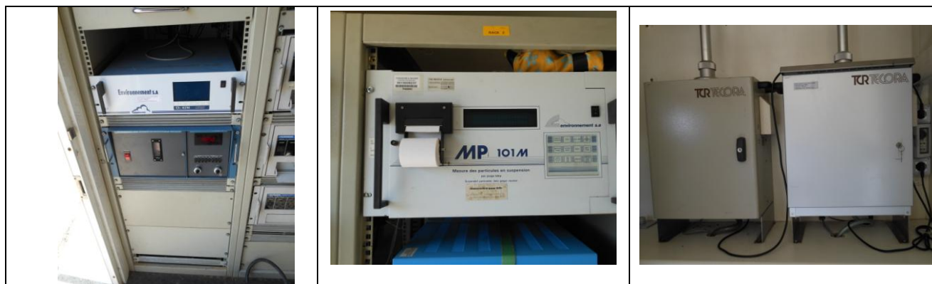
Foto 8: Mezzo mobile per monitoraggio della qualità dell'aria
