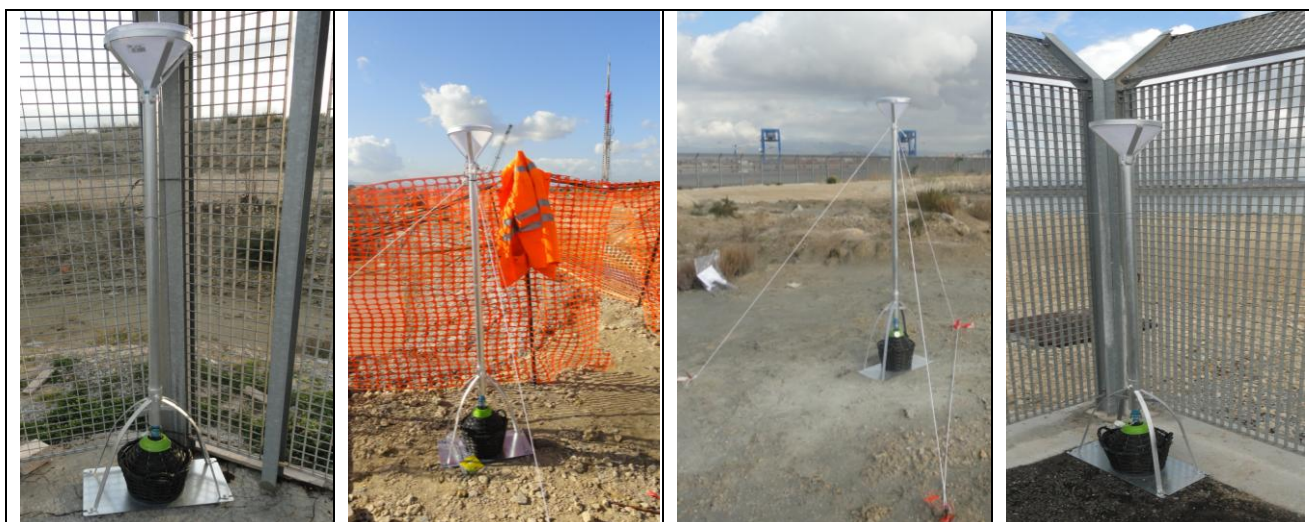
Foto 7: deposimetri installati rispettivamente 02-04-13-Ns
