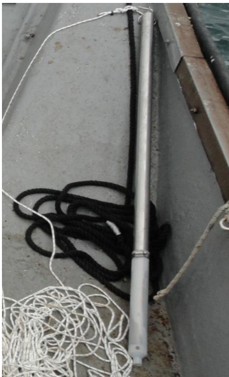
Foto 11: Bomb sampler utilizzato per il campionamento delle acque
