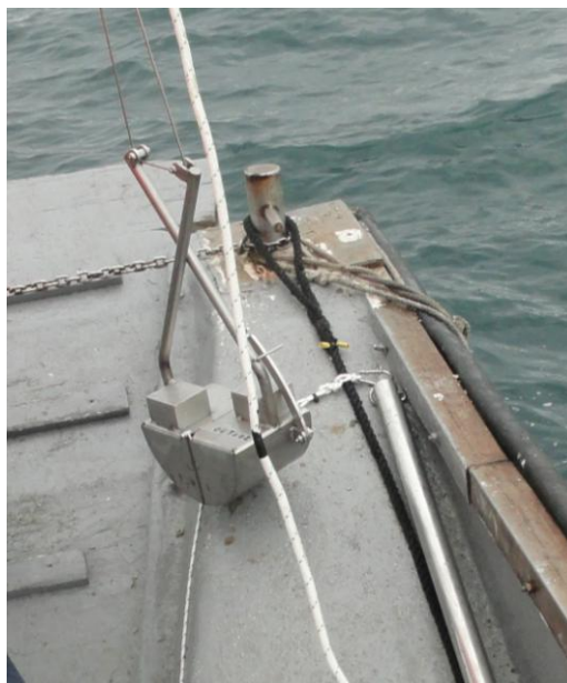
Foto 11: benna di Van Veen utilizzata per il campionamento dei sedimenti
