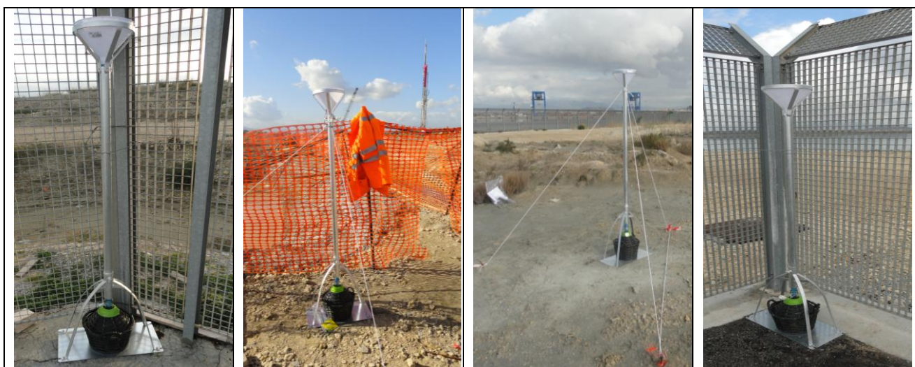
Foto 9: deposimetri installati rispettivamente 02-04-13-Ns
