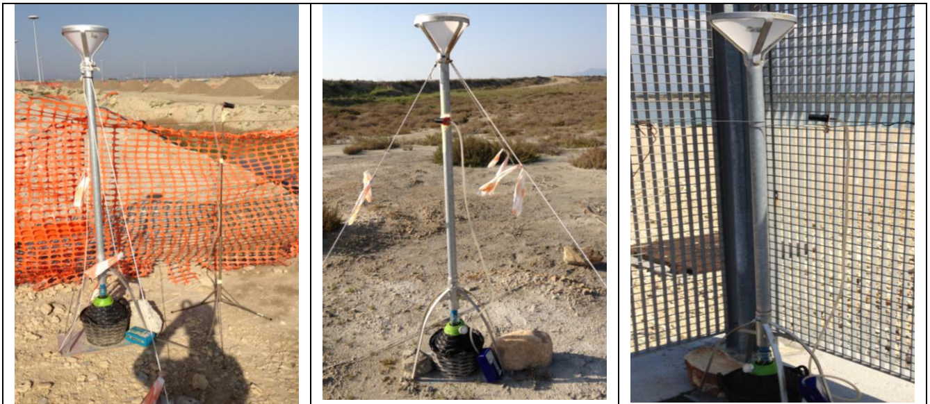
Foto 6: Vista delle tre stazioni di monitoraggio delle polveri
