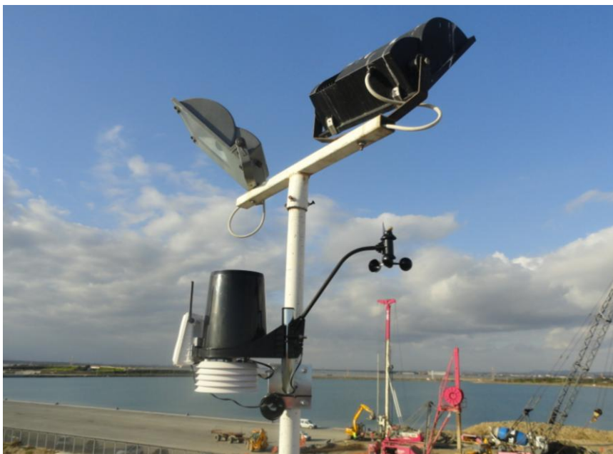
Foto 5: Centralina meteo fissa
