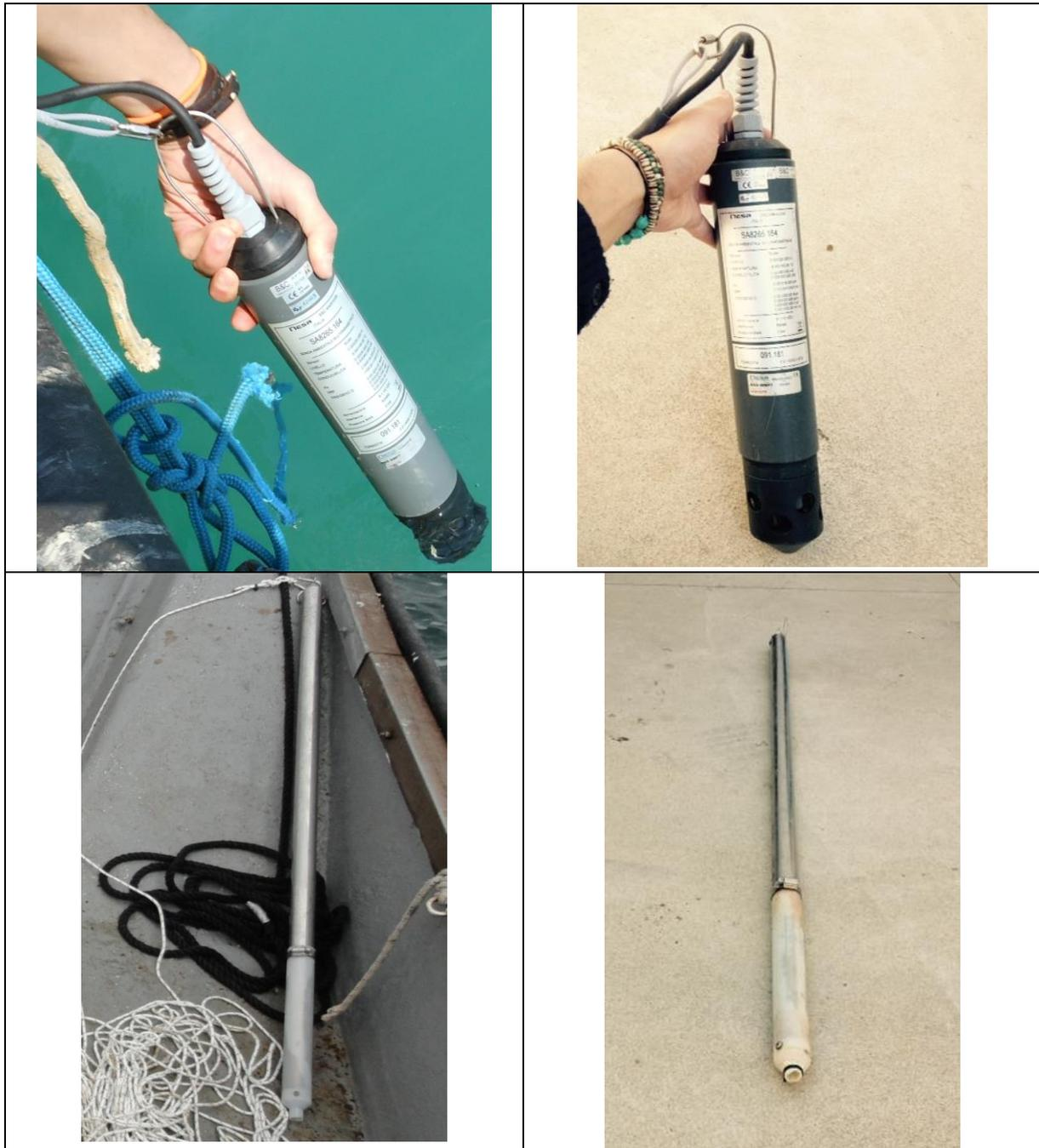
Foto 5: Sonda multiparametrica NESAs e Bomb sampler utilizzato per il campionamento delle acque
